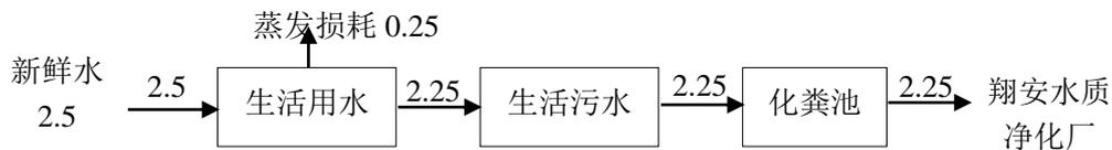
图 3-3 公司扩建工程水平衡图 (单位: t/d)
